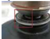
Dichtmittelanhaftungen aufdem Gleit- und Gegenring der Gleitringdichtung.
